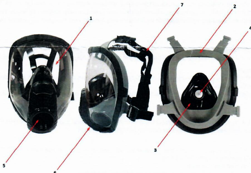
1 – wizjer, 2 – część twarzowa, 3 – półmaska, 4 – wkładka foniczna, 5 – układ wdechowy, 6 – układ wydechowy, 7 – nagłowie kpl.
